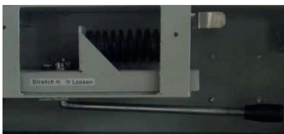
Lever de desserrage de la bande
